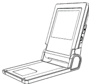
Рис. 1. Неправильная установка прибора
